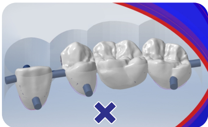
错误的排版方式① (破坏邻接点)
